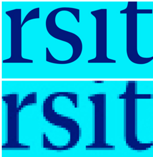
Figura 19. La imatge superior és el resultat d'ampliar un SVG amb el logotip de la UOC, i les lletres es veuen igual de nítides. La imatge inferior és el resultat d'ampliar un JPG. Font: David Casacuberta a partir d'una imatge propietat de UOC
